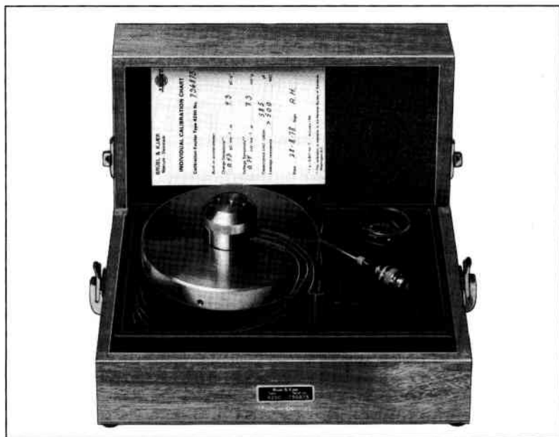
Рис. 5.14. Калибровочный вибростенд 4290 фирмы Брюль и Кьер
