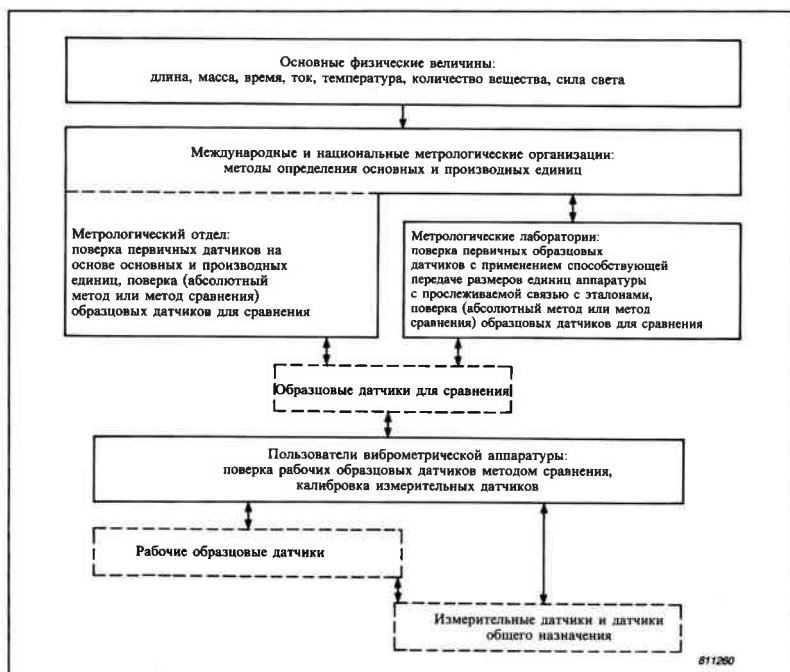
Рис. 5.4. Общая схема подчинения эталонов и образцовых вибродатчиков
