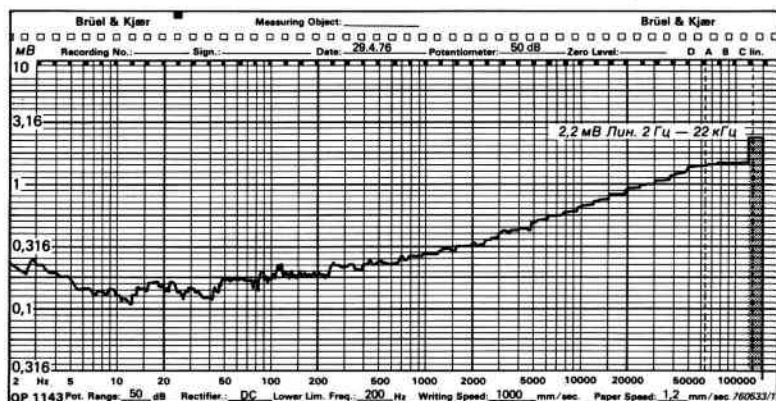
Рис. 3.12. Третьооктавный спектр собственного шума одного из усилителей заряда фирмы Брюль и Кьер
