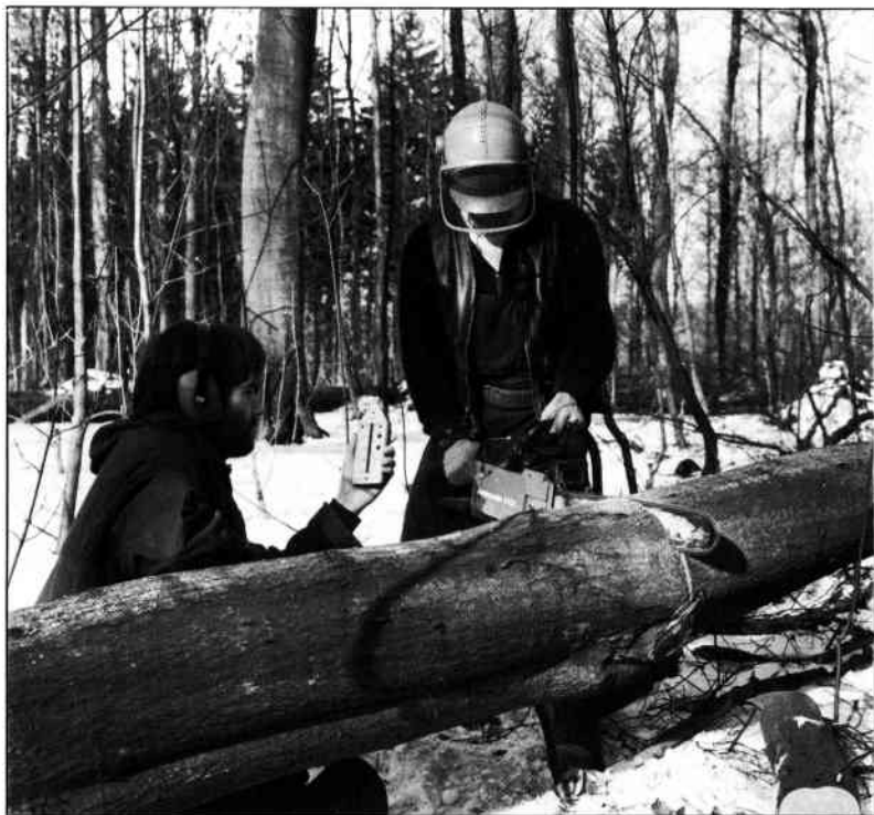
Рис. 1.4. Осуществляемые с помощью портативного виброметра и акселерометра исследования механических колебаний, передаваемых через рукоятку цепной пилы
