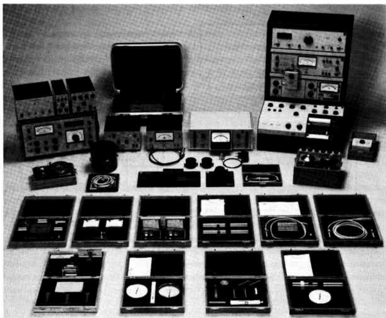
Рис. 5.17. Калибровочная система 9559 фирмы Брюль и Кьер
