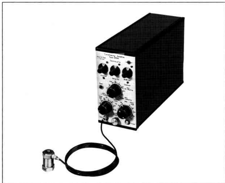
Рис. 5.6. Калибровочный набор 3506 фирмы Брюль и Къер
